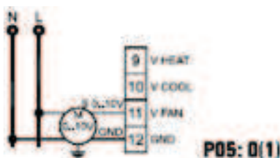
Conexión de un ventilador EC con entrada 0...10V.
